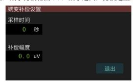
时间 0-99 秒,幅度 0.0-1.0uV。时间设为"0",表示关闭蠕变补偿。例如时间设为 20,幅度设为 0.3uV,表示在 20 秒内如果变化量小于 0.3uV,就把变化量做为蠕变进行补偿。
