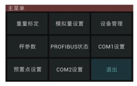
3、按"重量标定",输入密码(默认"123"),弹出标定流程选择界面,推荐选择"砝码标定"
