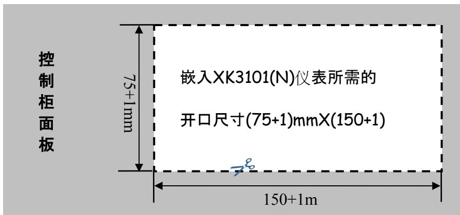
安装前请先将外壳两侧的顶杆拆下，然后将仪表由前面装入机柜中，将两只顶杆固定在仪表两侧，要求顶紧仪表外壳以保证牢固安装。机柜深度不小于180mm，方便接线。
