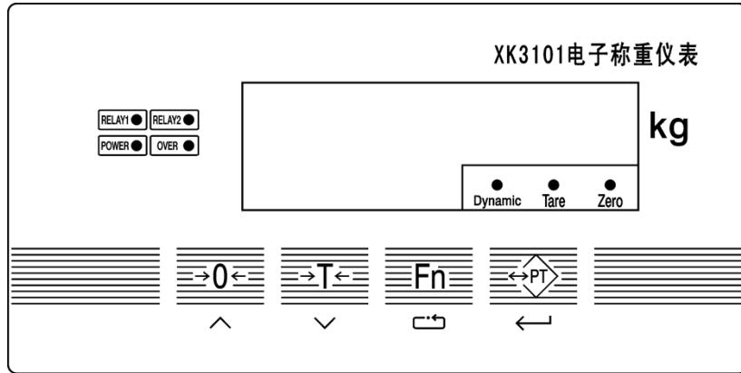
称重显示控制器显示面板上布置了四个按键，用于仪表的各种操作及参数设定。
