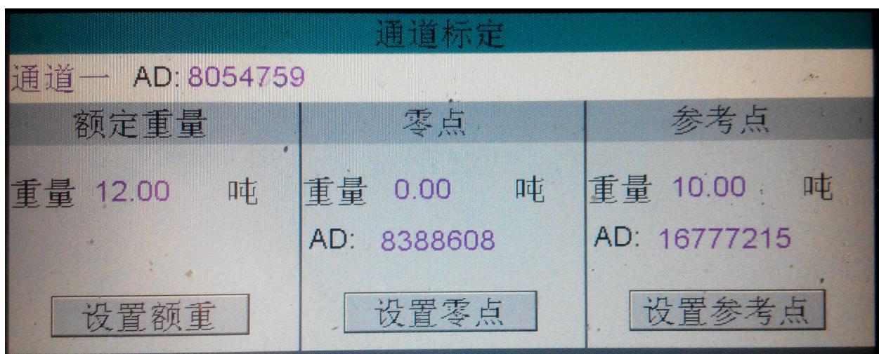
在设置额定重量时，根据提示，在编辑框输入正确的重量值后按“确认”即可。
