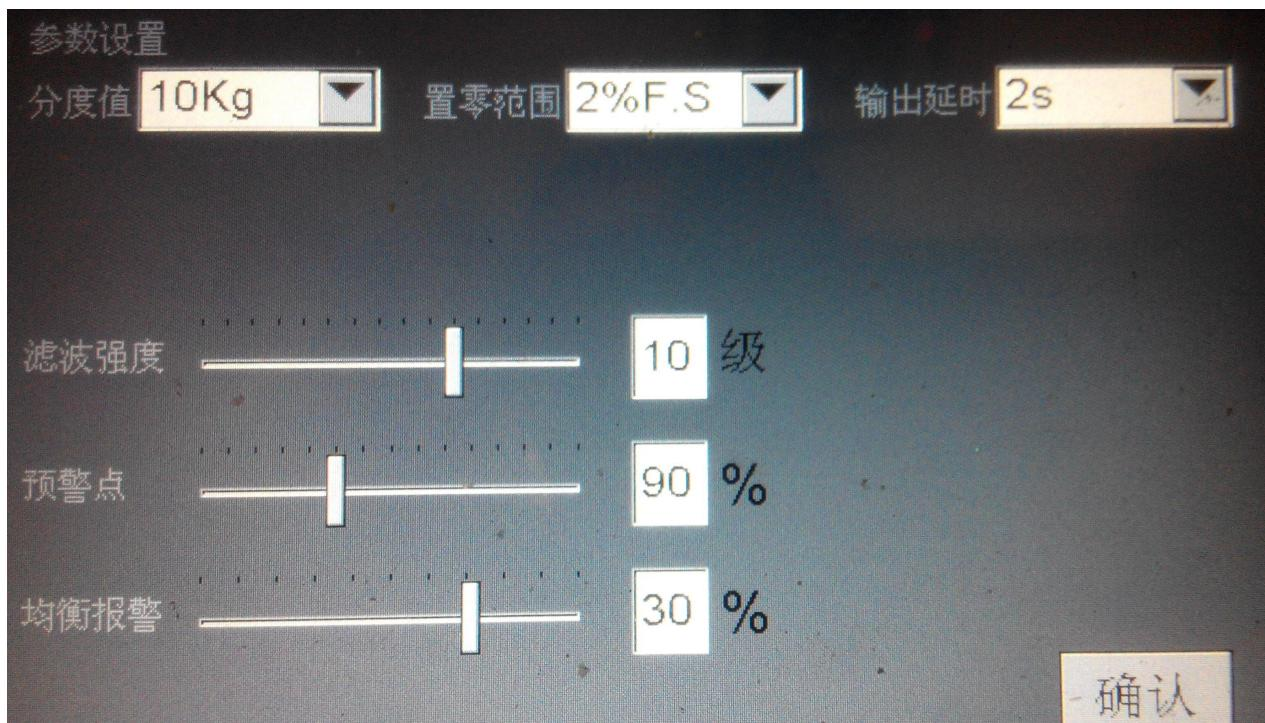
**分度值:**10kg表示重量的最低计量刻度为10kg, 低于10kg的将会被四舍五入, 仪表可以设置的范围分别是10kg、20、30kg、40kg、50kg、60kg、100kg。默认10kg。
