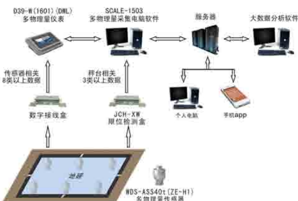
自动故障诊断汽车衡系统
